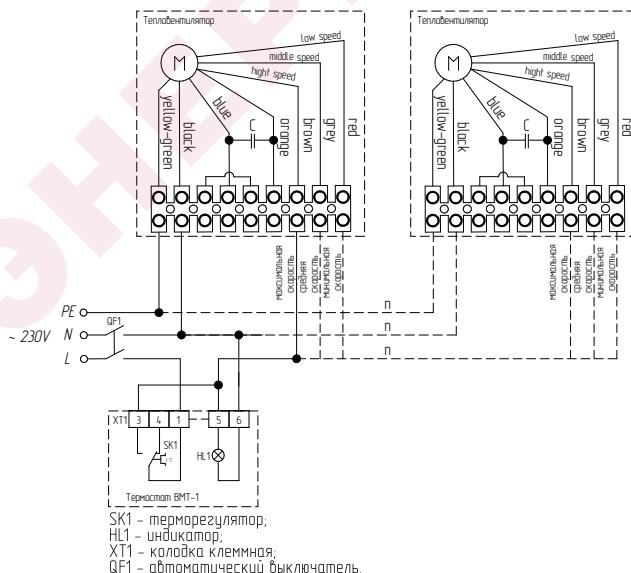
**Подключение водяного тепловентилятора к термостату ВМТ-2, осуществление регулировки температуры воздуха, подачей теплоносителя.**
