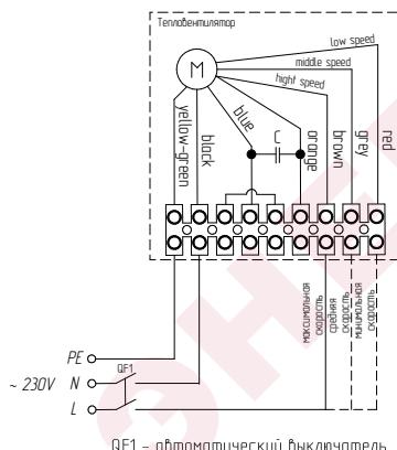
**Схема подключения к термостату BMC-1**
