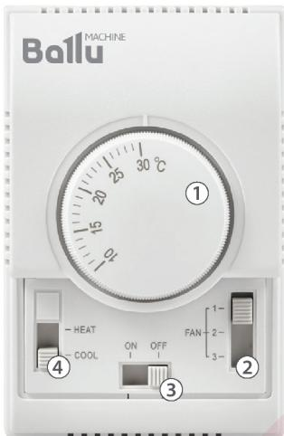
Термостат BMC-1, при помощи встроенного механического термостата, поддерживает необходимую температуру в помещении при помощи включения и выключения вентилятора
