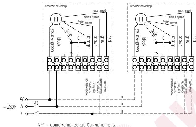
**Подключение водяного тепловентилятора
