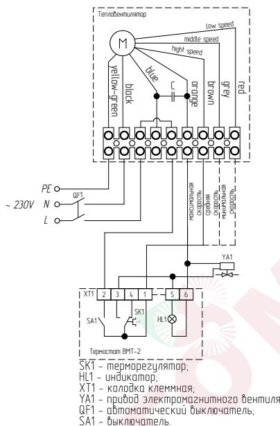
**Групповое подключение водяных тепловентиляторов к термостату ВМТ-2, осуществление регулировки температуры воздуха, подачей теплоносителя.**
