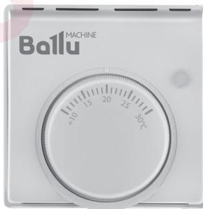
Термостат механический BMT-1 применяется для регулирования поддерживаемой в помещении температуры. В качестве чувствительного элемента используется сильфон, заполненный газом. Обычно применяется в коммерческих помещениях, в домашних системах отопления и кондиционирования воздуха совместно с климатической техникой. Данный термостат не устанавливается в помещениях с повышенной влажностью и в агрессивных средах (Класс защиты IP40).
